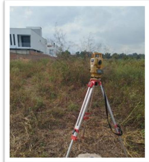
Levantamiento topográfico con estación total.
