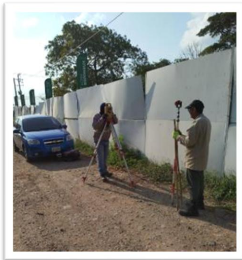
Levantamiento topográfico con estación total.
